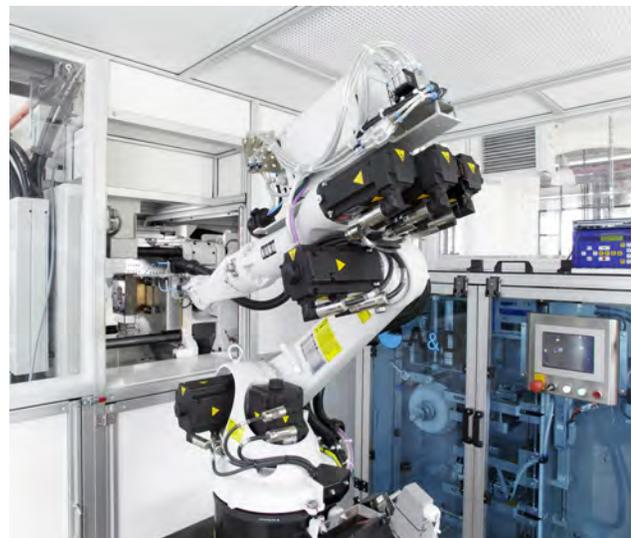
Einsatz eines Sechs-Achs-Roboters in einer Reinraumbox der Klasse 7.
